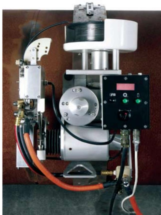
поворотных кольцевых стыков в нефтегазовом комплексе, где сварка ведется двумя головками. В экстренных случаях возможно использование двух левых или двух правых головок на одном поясе.
