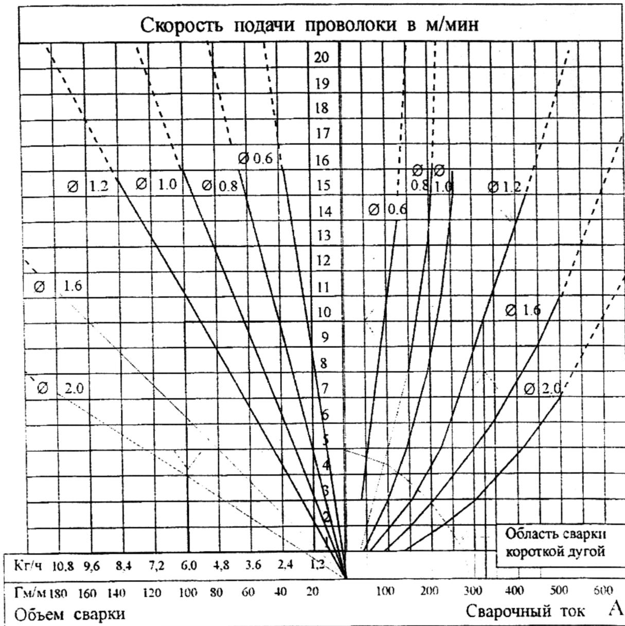
Рис 1 - Ориентировочные параметры сварки.
