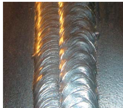
Рис.6 Общий вид облицовочного шва (в два валика) на проволоке POWER BRIDGE 60M (x6).
