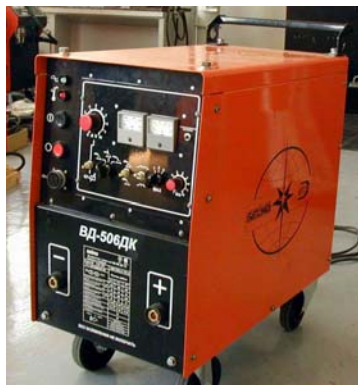
Рис.5 Сварочный выпрямитель ВД-506ДК.
