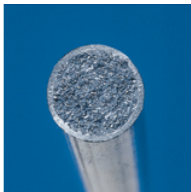
Рис.4 Сечение металлопорошковой проволоки POWER BRIDGE 60M.
