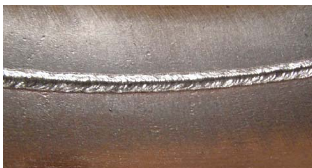
Рис.7 Вид обратного валика сформированного на весу при сварке проволокой сплошного сечения типа ПСГ-03.01 (А) и металлопорошковой проволокой типа POWER BRIDGE 60М (Б) диаметром 1,2 мм на установке ВД-506ДК.
