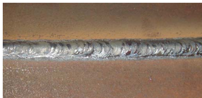
Рис.7 Вид обратного валика сформированного на весу при сварке проволокой сплошного сечения типа ПСГ-03.01 (А) и металлопорошковой проволокой типа POWER BRIDGE 60М (Б) диаметром 1,2 мм на установке ВД-506ДК.
